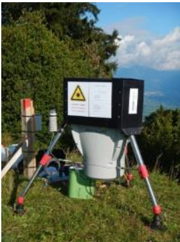
Abb. 4 SpiDAR Wind LIDAR, temporäre Windmessungen Oberfeld, (Sept-Nov. 2014) und 100 m Windmessmast seit Juli 2015 in Betrieb
